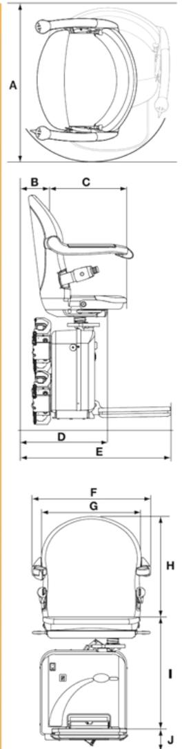
\* Abstand zwischen Fußstütze und Sitz wird auf 477 mm reduziert, wenn die Fußstütze im höchsten Stand (90 mm) montiert wird.
